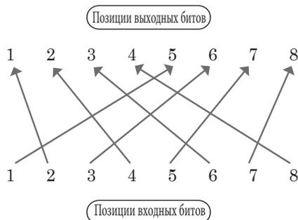
Рис. 2.14. Другая форма записи начальной перестановки  $IP^{-1}$
